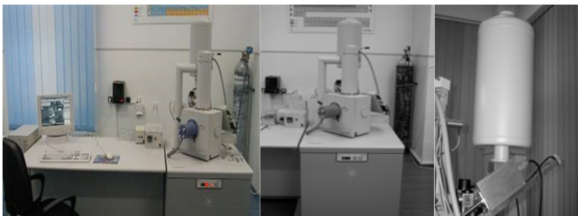
Figura 5.4. Microscop electronic de baleiaj Philips model ESEM XL 30 TMP, dotat cu un spectrometru după energii EDAX
