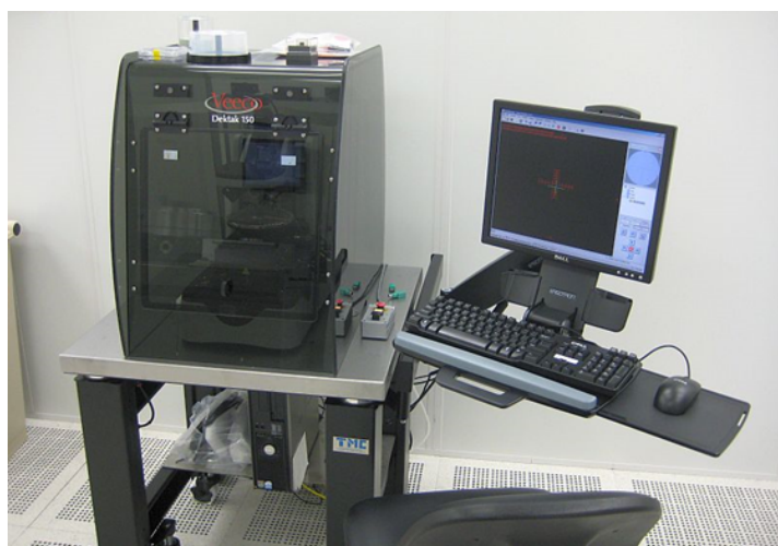
Figura 4.3. Dispozitivul utilizat pentru determinarea rugozității suprafeței
