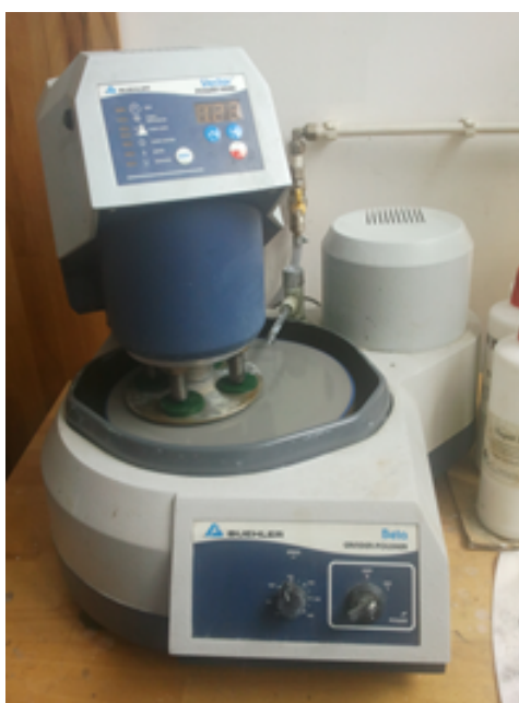
Figura 5.11. Aparatul de șlefuit și lustruit Buehler Beta & Vector Grinder-Polisher
